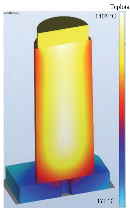
Obr. 11 Počáteční teplotní pole ingotu a licí podložky, varianta N.3, rozsah teplot 171 – 1407 °C
