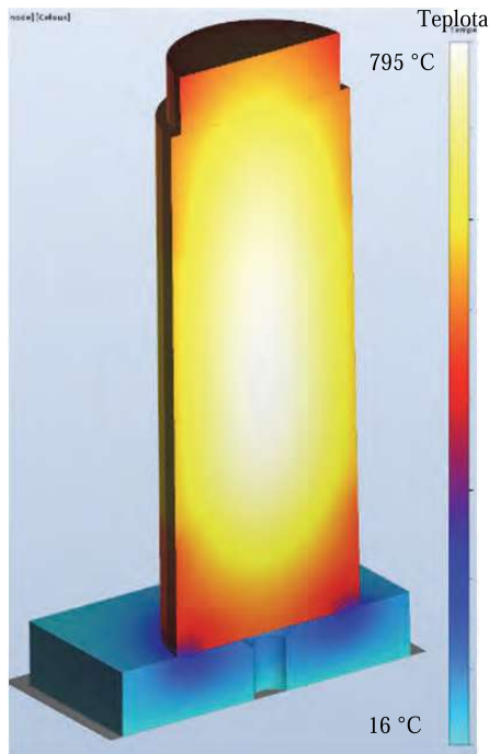
Obr. 12 Teplotní pole ingotu a lící podložky po 5 hodinách chlazení, varianta N.3, rozsah teplot 16 – 795 °C
