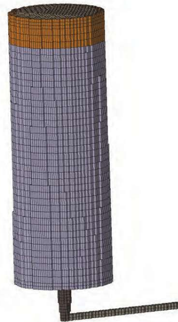
Obr. 5 Výpočetní síť modelované geometrie kruhového těžkého kovářského ingotu
