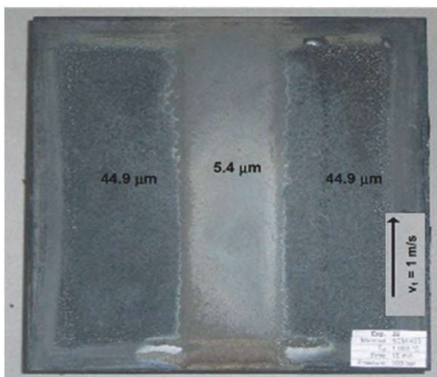
Obr. 13 Experimentální deska se zamraženou strukturou okují Fig. 13 Experimental plate with frozen scale structure
