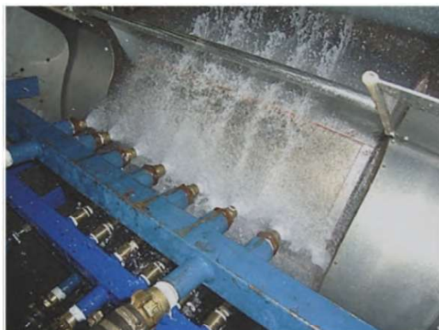
Obr. 1 Experimentální válec pro určení součinitele přestupu tepla Fig. 1 Experimental roll serving for determination of heat transfer coefficient
