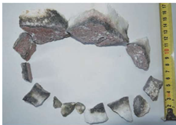
Obr. 13 Vybouraná stěna kelímku IP; červená část byla v kontaktu s taveninou, bílá část přiléhala k plášti kelímku
