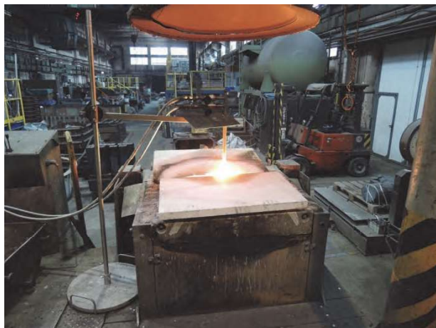
Obr. 3 Atmosférická indukční tavící pec s kyslíko-palivovým hořákem v průběhu experimentální tavby se zakrytým kelímkem pomocí sibralových desek
