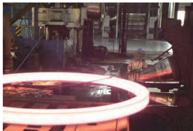
Obr. 6 Rozválcování kroužku ve firmě Bohemia Rings, s.r.o., Zámrsrk Fig. 6 Rolling of ring in the company Bohemia Rings, s.r.o., Zámrsrk
