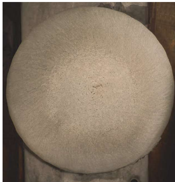
Obr. 4 Příčný makrorept předlitku ø 600 mm s použitím EMS
