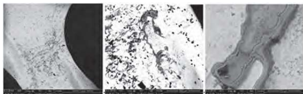
Obr. 2 Oblast koroze na košíčkové fréze při zvětšení 30×, 100×, 1000× (SEM, 20 kV, BSED)
