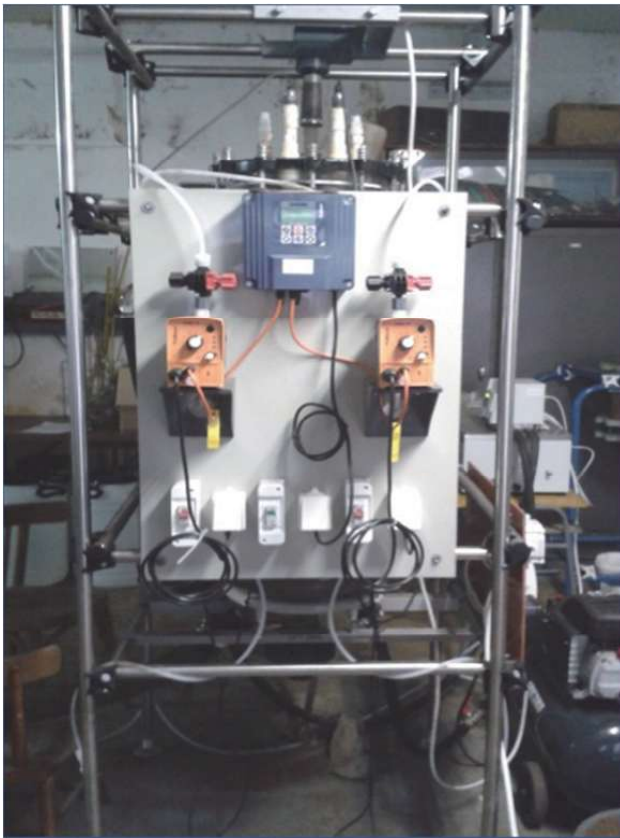
Obr. 3 Systém automatickej regulácie pH (vľavo) a lúhovací reaktor (vpravo) Fig. 3 Automatic pH control system (left) and leaching reactor (right)
