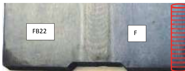
Obr. 3 Svařenec s naznačením místa přípravy zkušebních tělísek z oceli F
