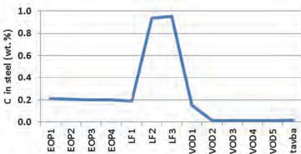
Fig. 13 The course of the content of C in steel during production in EAF and processing in LF and VOD of X2CrNiMo13-4 quality Obr. 13 Průběh obsahu C v oceli během výroby v EOP a zpracování oceli na LF a VOD jakosti X2CrNiMo13-4
