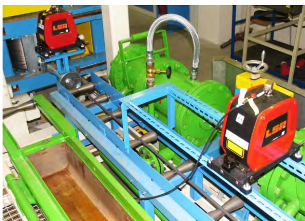
Obr. 4 Měření povrchové teploty skenerem LandScan (LSP) během volného ochlazování vývalku na vzduchu (uprostřed – modrá konstrukce válečkového dopravníku; zeleně kalící vana vlevo, resp. systém zrychleného ochlazování tlakovou vodou vpravo) Fig. 4 Measurement of the surface temperature in the course of free cooling of the rolled product by temperature scanners LandScan
