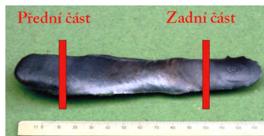
Obr. 3 Ingot předslitiny TaAl-1 připravený plazmovým tavením Fig. 3 Ingot of master alloy TaAl-1 prepared by plasma melting
