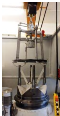
Obr. 8 Snímání sběrného koše s tažného bubnu
