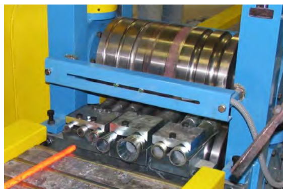
Obr. 1 Předválcovací stolice s max. průměrem válců 350 mm Fig. 1 Roughing mill with the maximum roll diameter of 350 mm
