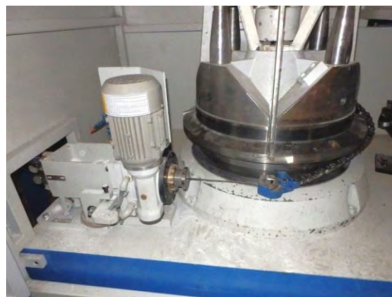
Obr. 6 Drátotah KOCH KGT 25 - E: rotační držák průvlastku a tažný buben v okamžiku zatahování drátu
