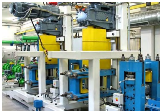
Obr. 2 Čtyřstolicové spojitě pořadí laboratorní válcovny tyčí Fig. 2 Continuous four-stands train of the laboratory bar-rolling mill
