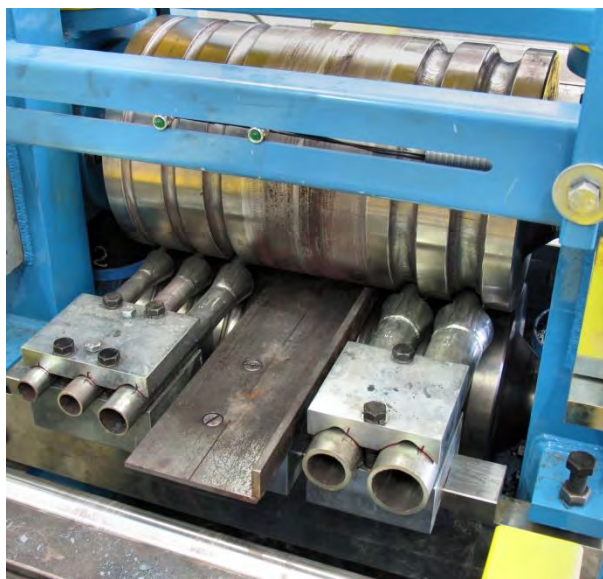
Obr. 1 Pohled na vstupní stranu laboratorní válcovací stolice (se stolem nahrazujícím armatury u hladké části válců)
