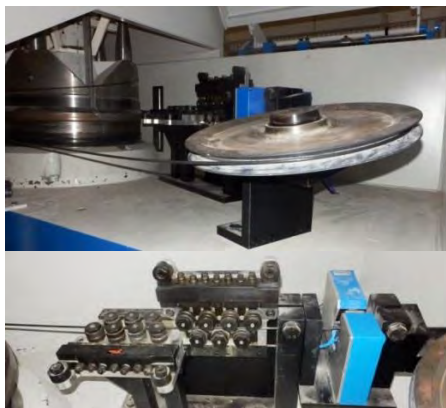
Obr. 7 Nahore: převíjecí kladka, dole: laserové měření rozměrů a rovnačka
