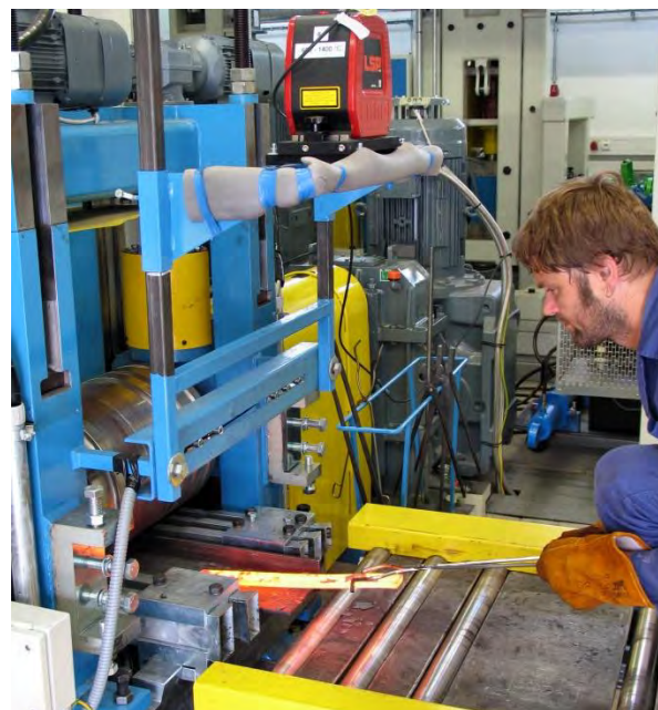
Obr. 3 Čekání na dosažení žádané teploty provalku před druhým průchodem
