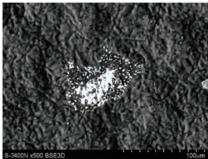
Obr. 8 Povrch vzorky MAR-M247 s Al povlakom po 18 cykloch Fig. 8 Surface of MAR-M247 sample with Al coating after 18 cycles
