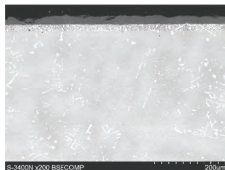
Obr. 6 Mikroštruktúra MAR-M247 s povlakom pred testovaním Fig. 6 Microstructure of MAR-M247 with coating before testing
