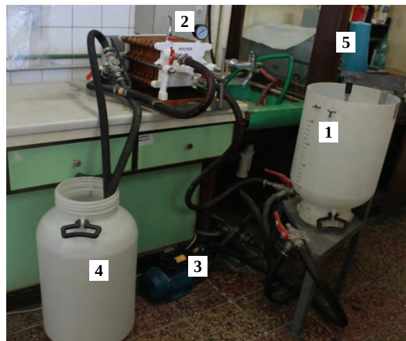
Obr. 1 Filter Filtrex D18 (1 – nádoba so vstupným vínom, 2 – doskový filter Filtrex, 3 – čerpadlo, 4 – výstupný filtrát, 5 – stálie miešanie filtrátu)
