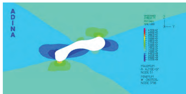
Obr. 4 Rozloženie napätia v oblasti okolia jednej grafitickej častice Fig. 4 Distribution of the stress around graphitic particle with vermicular shape
