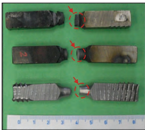
Obr. 4 Vzorky po statickej skúške v ťahu (Toolox 33) [2] Fig. 4 Samples after the static tensile test (Toolox 33) [2]
