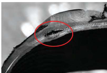
Obr. 4 Pozdĺžna trhlina v ramene plášt'a medzi prvým a druhým nárazníkom Fig. 4 Kongitudinal crack in the area of the shoulder and in the site between the first and the second buffer lining
