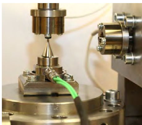
Obr. 3 Kalibrace piezoelektrického snímače sil s osazeným pinem Fig. 3 Calibration of piezoelectric force transducers
