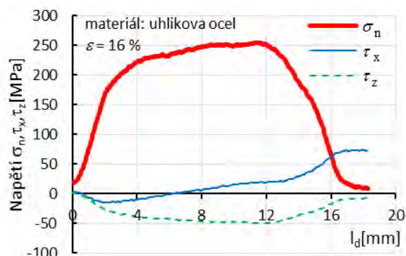
Obr. 9 Distribuce napětí ve válcovací mezeře při válcování uhlíkové oceli za tepla, exp. H7
