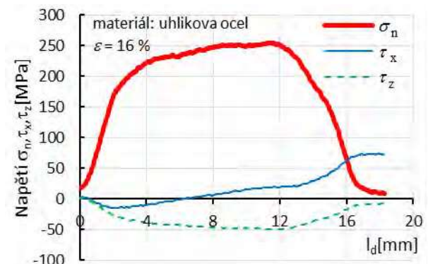
Obr. 9 Distribuce napětí ve válcovací mezeře při válcování uhlíkové oceli za tepla, exp. H7
