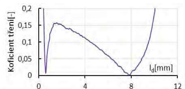
Obr. 7 Distribuce koeficientu tření ve válcovací mezeře v obvodovém směru při válcování hliníku za studena, experiment C1
