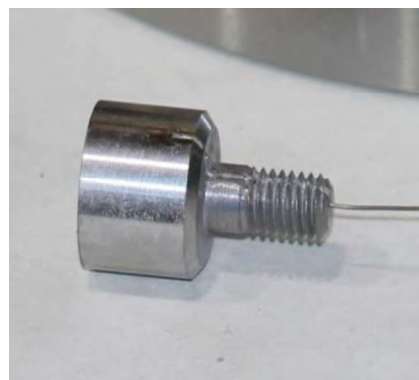
Obr. 4 Teplotní čidlo pro zabudování do pracovního válce Fig. 4 Temperature sensor before installation into the work roll
