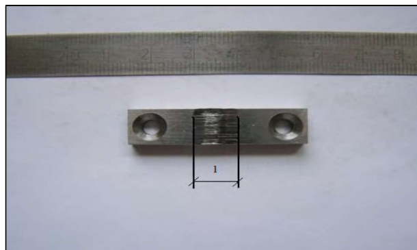
Obr. 7 Délka zábrusu, l Fig. 7 Length of friction zone, l
