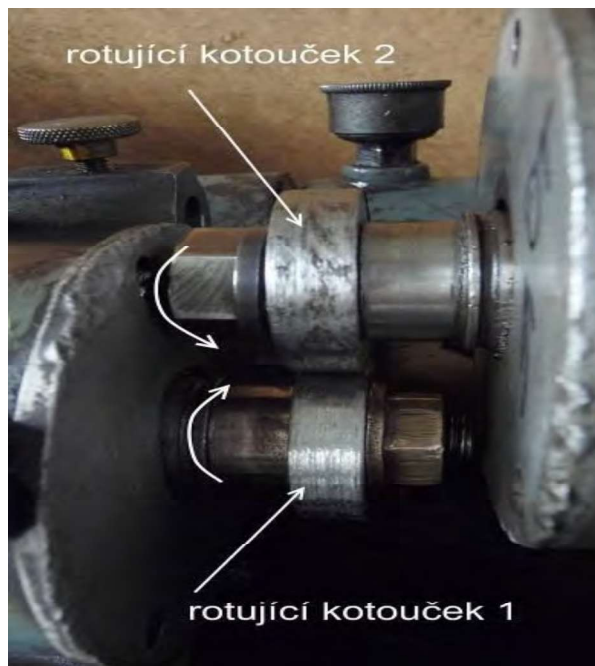
Obr. 9 Zkušební sestava – režim valivého tření Fig. 9 Testing assembly – rolling friction testing mode
