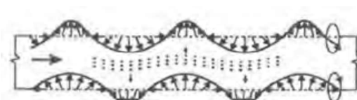
Obr. 2 Antisymetrická Lambova vlna Fig. 2 Anti-symmetrical Lamb wave
