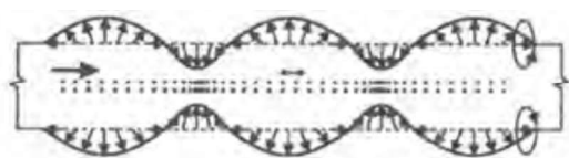
Obr. 1 Symetrická Lambova vlna Fig. 1 Symmetrical Lamb wave
