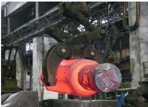
Obr. 5 Výroba kovářenského ingotu Fig. 5 Manufacture of ingot for forging
