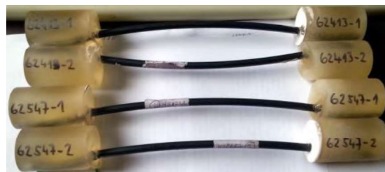
Obr. 3 Uchycení drátů v dentakrylových pouzdech
