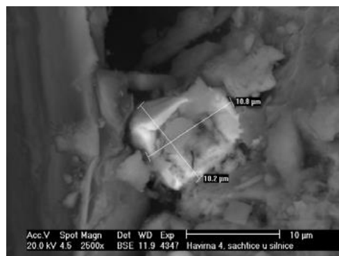
Obr. 10 Částice 4347 z H3 o složení (hm.%): 36,68 O; 2,05 Na; 0,55 Mg; 6,68 Al; 16,82 Si; 1,74 P; 20,45 Zr; 0,17 S; 0,00 Pb; 0,40 Ag; 1,22 K; 3,57 Ca; 0,55 Ti; 0,11 Cr; 0,29 Mn; 7,63 Fe; 0,43 Zn
