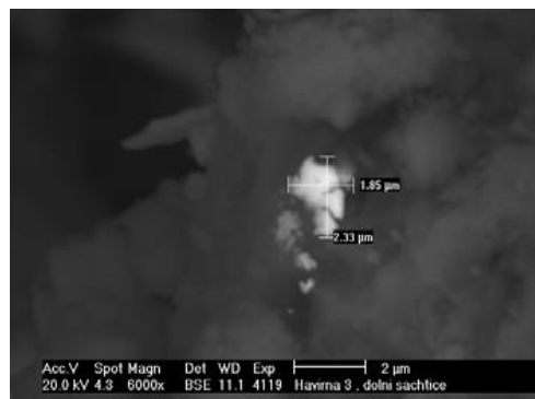
Obr. 8 Částice 4119 z H2 o složení (hm.%): 15,45 O; 1,56 Na; 0,88 Mg; 3,71 Al; 3,71; 6,70 Si; 0,87 P; 7,50 S; 57,58 Pb; 1,40 Ag; 0,99 K; 0,37 Ca; 0,25 Ti; 0,28 Cr; 0,32Mn; 0,75 Fe; 1,09 Cu
