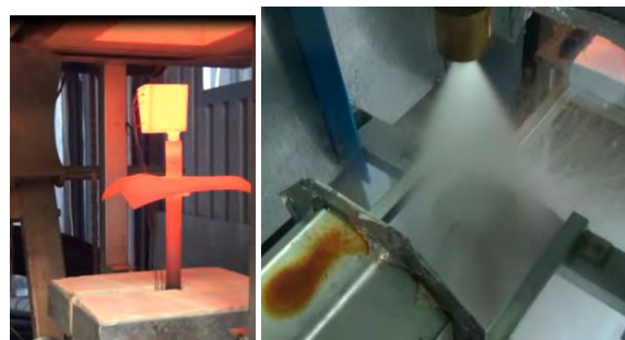
Obr. 4 Fotografie testovacího vzorku po vyjmutí z pece (vlevo) a v průběhu chlazení tryskou (vpravo)
