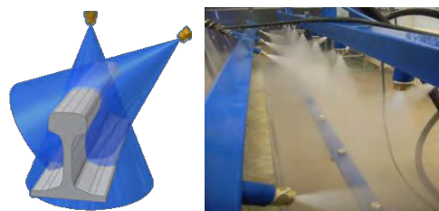
Obr. 10 Laboratorní chladicí sekce sloužící k tepelnému zpracování kolejnic
