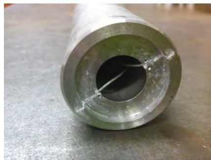
Obr. 4 Zabudování termočláneků do zkušebního tělesa
