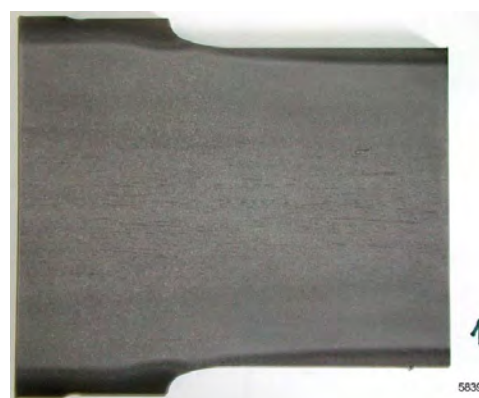
Obr. 1 Makrolept řezu nápravy z oceli EA4T oblasti přechodu ze sedla pohonu (větší průměr) do dířku, leptáno 10% HNO_3 (se svolením výrobce BONATRANS GROUP a.s.)
