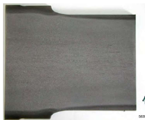
Obr. 1 Makrolept řezu nápravy z oceli EA4T oblasti přechodu ze sedla pohonu (větší průměr) do dříku, leptáno 10% HNO_3 (se svolením výrobce BONATRANS GROUP a.s.)
