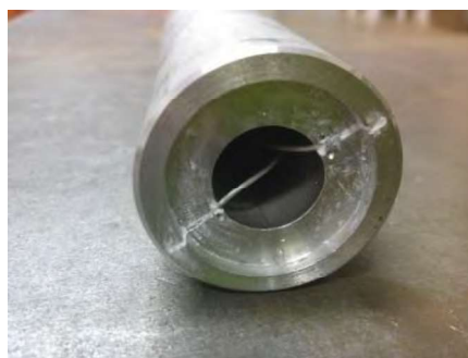
Obr. 4 Zabudování termočláanky do zkušební tělesa
