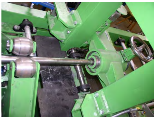
Obr. 1 Detail uložení děrovací tyče v opěrném ložisku
