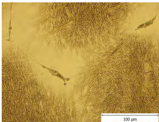
Obr. 5 Kontaminace hranic zrn cizími fázemi (po ohřevu 1240 °C / 1 h) Fig. 5 Grain boundary contamination by unfamiliar phases (after heating at 1240 °C / 1 h)
