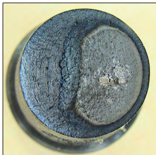
Lomová plocha vzorku o průměru 10 mm.
