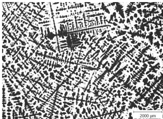
Obr. 2 Dendritická lící struktura u vzorku žíhaného při 1200 °C / 5 h
