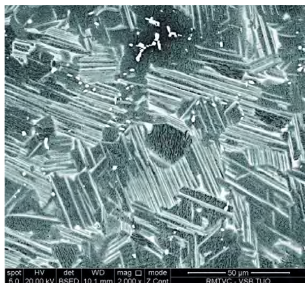
Obr. 8 Mikrostruktura vzorku 8Nb-Y po následném žhání Fig. 8 Microstructure of the 8Nb-y sample after the next annealing
