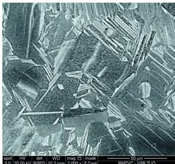
Obr. 7 Mikrostruktura vzorku 8Nb po následném žhání Fig. 7 Microstructure of the 8Nb sample after the next annealing
