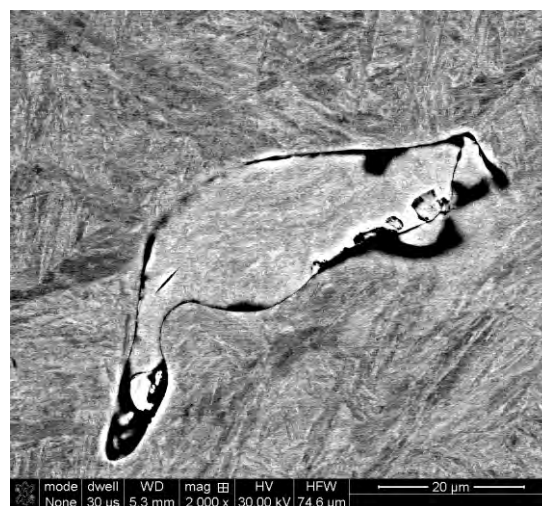
Obr. 7 Částečně vyplněná dutina ve vzorku ohřívaném 1200 °C / 5 h Fig. 7 Partially filled cavity in the sample heated at 1200 °C / 5 h
