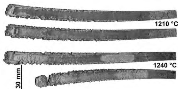
a) Půdorysný tvar vzorků vyválcovaných při teplotách nad 1200 °C a) Top view of the samples rolled at the temperatures above 1200 °C
