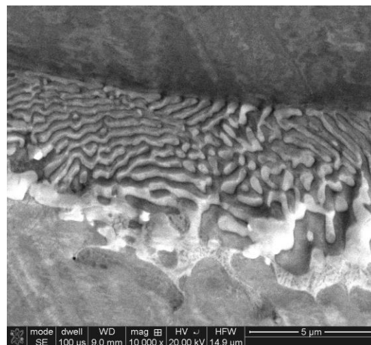
Obr. 6 Malý eutektický útvar na hranici zrn (po ohřevu 1240 °C / 1 h) Fig. 6 Small eutectic formation on the grain boundaries (after heating at 1240 °C / 1 h)
