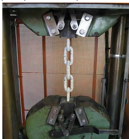
Obr. 8 Tahová zkouška řetězu Fig. 8 Tensile test of chain
