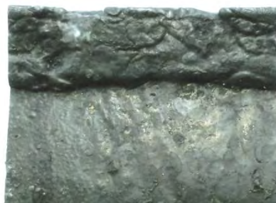
Obr. 5 Povrch na úzkej stene bramy – pokračovanie výronu, vzorka 3A Fig. 5 Slab surface on the narrow face – continuation of shell tearing, sample 3A
