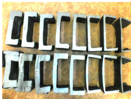
Obr. 20 Rezy úzkych stien zliatku z kryštalizátora Fig. 20 Cut-outs from shell of the breakout
