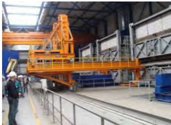
Obr. 4 Pece pro tepelné zpracování a obslužný manipulátor
