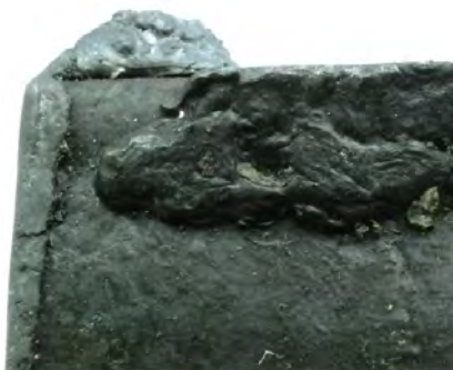
Obr. 4 Povrch na úzkej stene bramy – začiatok výronu, vzorka 3B Fig. 4 Slab surface on the narrow face – start of shell tearing, sample 3B
