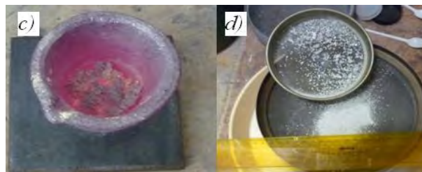
Obr. 1 Predúprava cínového steru pre testovanie (a-ster, b - získaný kov a sekundárny ster, c - oxidácia, d - jemný oxidický prášok)
