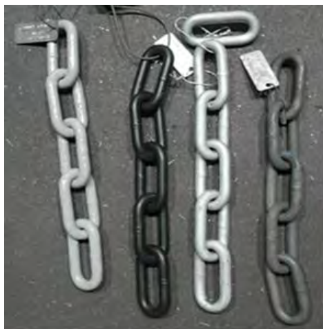
Obr. 3 Řetězy s různou úpravou povrchu (zleva č. 1, 2., 3., 4.) Fig. 3 Chains with various surface treatments (from the left Nos.1, 2, 3, 4)
