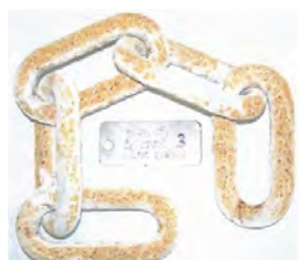
Obr. 6 Vzorek č. 3 po korozní zkoušce Fig. 6 Sample No. 3 after corrosion test
