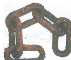
Obr. 7 Vzorek č. 4 po korozní zkoušce Fig. 7 Sample No. 4 after corrosion test
