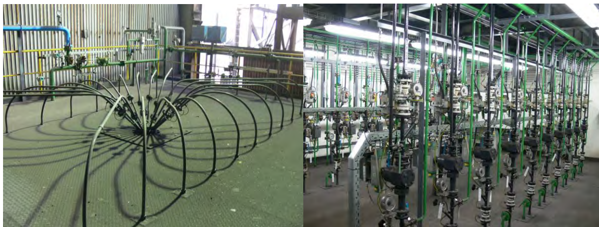
Obr. 4 Dynamické distributory prachového uhlí na vysokých pecích Fig. 4 Dynamic distributors of powder coal on BF's
