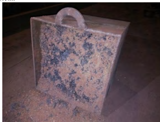
Obr. 3 Nespečená horní vrstva vzorku vysypaná z krabice
