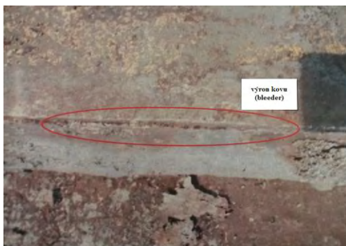
Obr. 2 Mikroprieval Fig. 2 Bleeder
