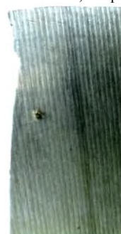
Obr. 7 Priečný rez úzkej steny bramy, vzorka 2B Fig. 7 Cross section of the slab narrow face, sample 2B
