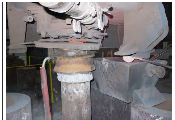
Obr. 8 Ochrana lícího proudu v provozních podmínkách Fig. 8 Protection of casting stream in industrial conditions
