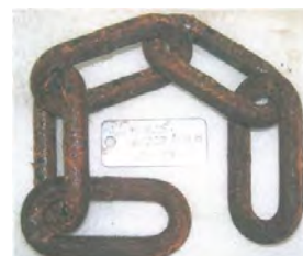
Obr. 5 Vzorek č. 2 po korozní zkoušce Fig. 5 Sample No. 2 after corrosion test
