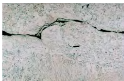
Obr. 11 Detail studeného spoja, vzorka 1B1 Fig. 11 Detail of cold joint, sample 1B1
