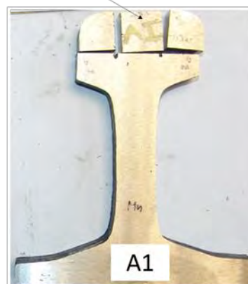
Obr. 2 Vzorek AI vyřezaný ze segmentu kolejnice A1 Fig. 2 The sample AI - cut from the rail segment A1
