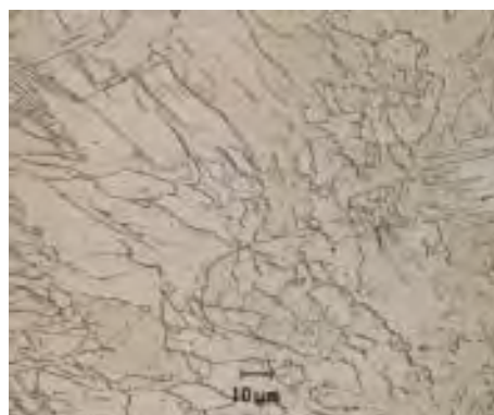
Obr. 15 Štruktúra vo výrone vzorka 3A2 Fig. 15 Bleeder structure, sample 3A2
