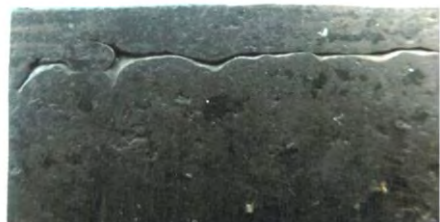
Obr. 28 Výron kovu na širokej stene, vzorka LS 6 Fig. 28 Shell tearing on a wide face, sample LS 6
