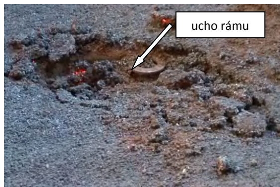
Obr. 2 Vzájemné spečení vzorku a cca 7cm vrstvy aglomerační směsi
