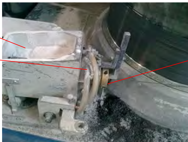
Obr. 6 Umístění průvlaku v průvlakovém boxu drátotahu Fig. 6 Location of the die in the die box of drawing machine
