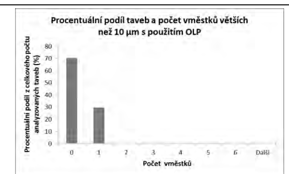
Obr. 11 Procentuální počet taveb s daným počtem vměstků větších než 10 µm s použitím OLP Fig. 11 Percentage share of heats with given number of inclusions bigger than 10 µm, with use of the CSP
