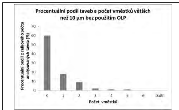
Obr. 12 Procentuální počet taveb s daným počtem vměstků větších než 10 \mu\text{m} bez použití OLP Fig. 12 Percentage share of heats with given number of inclusions bigger than 10 \mu\text{m} , without use of the CSP
