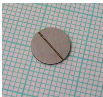
Obr. 1 Zkušební těleso tvaru disku s „U“ vrubem v ose roviny disku [5] Fig. 1 Disc test specimen with „U“ notch in the axis of disc plane [5]
