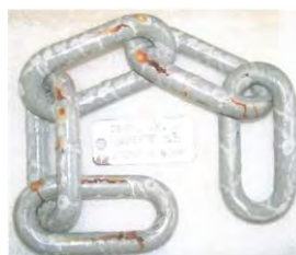
Obr. 4 Vzorek č. 1 po korozní zkoušce Fig. 4 Sample No. 1 after corrosion test
