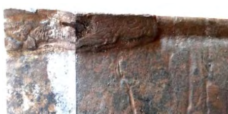
Obr. 27 Výron kovu na prievalovej brame, vzorka LS 3 Fig. 27 Shell tearing on the break-out slab, sample LS3
