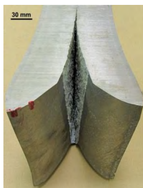
Obr. 1 Delaminace rozvalku ze slitiny AlMg 4,5 Mn 0,7 (aktuální tloušťka 96 mm)
