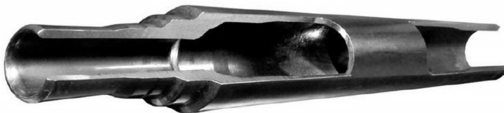
Obr. 17 Pouzdro vykované radiálním kováním s použitím trnu [7]
