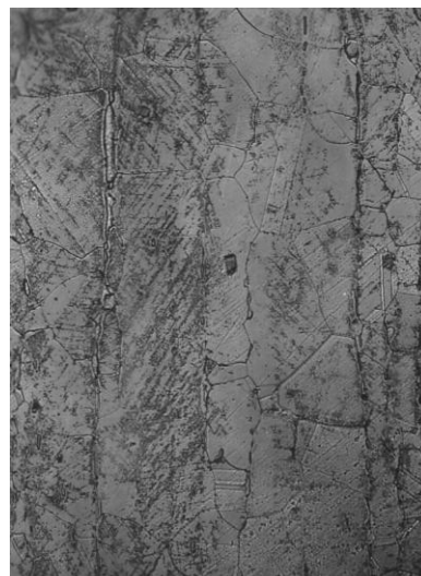
Fig. 4 Microstructure of the metal plate semi-product, zoomed 400x Obr. 4 Mikroštruktúra polotovaru plechu, zväčšenie: 400x
