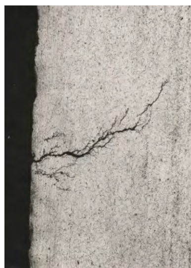
Fig. 6 Propagation of the main crack and lateral cracks, zoomed 100x Obr. 6 Šírenie hlavnej trhliny a bočných trhlín, zväčšenie: 100x
