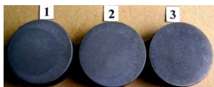
Fig. 2 Cross-sections of continuously cast round rods Obr. 2 Priečne rezy kontinuálnych tyčí
