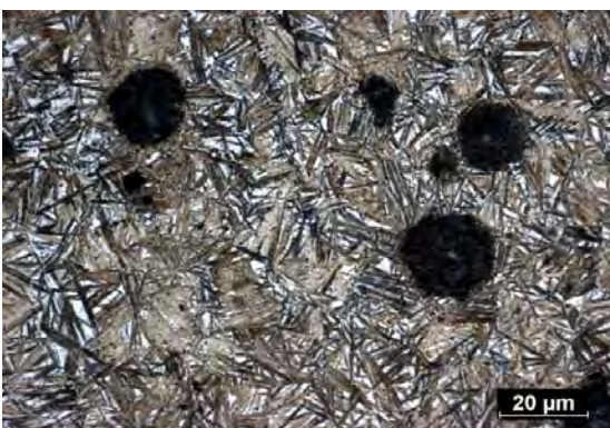
Fig. 3 Microstructure of austempered ductile iron Obr. 3 Mikrostruktura litiny s kuličkovým grafitem ve stavu ADI
