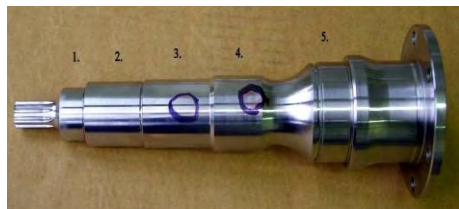
Fig. 2 The failure of the shaft before the further processing operation Obr. 2 Porušenie hriadeľa pred ďalším spracovaním
