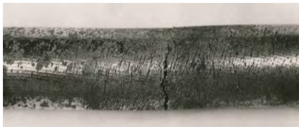
Fig. 2 Cracks on the bolt, zoomed 2.1x Obr. 2 Trhliny na skrutke, zväčšenie: 2,1x
