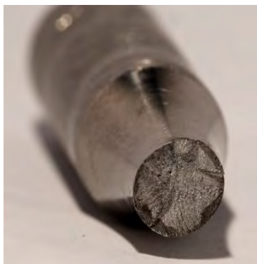
Fig. 3 Fatigue fracture of the material Obr. 3 Únavový lom materiálu
