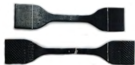
Fig. 2 Elastomeric samples: before tensile test (upper sample) and after rupture Obr. 2 Elastoméne vzorky: pred ťahovou skúškou (hore) a po pretrhnutí
