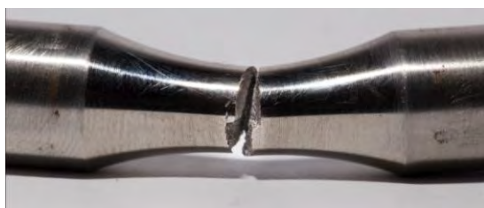
Fig. 4 Fatigue crack of the material Obr. 4 Únavová trhлина materiálu
