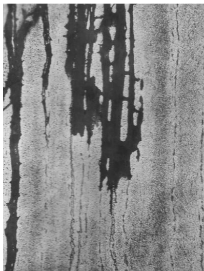
Fig. 7 Corrosion attack of the delta ferrite, zoomed 400x Obr. 7 Korózne napadnutie feritu delta, zväčšenie: 400x
