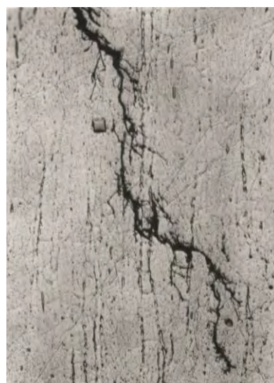
Fig. 5 Branching of the crack, zoomed 400x Obr. 5 Vetvenie trhliny, zväčšenie: 400x
