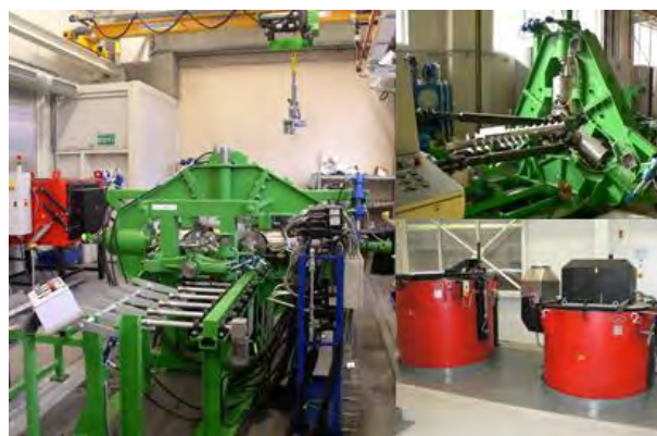
Obr. 2 Laboratorní válcovací stolice bezešvých trubek Fig. 2 Laboratory rolling mill for production of seamless tubes
