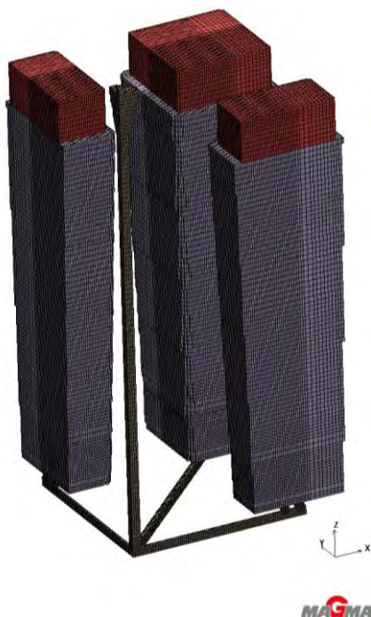
Obr. 2 Nasíťování lící sestavy, těla ingotů z Kokily H a jeho hlavového nástavce Fig. 2 Meshing of the casting assembly, bodies of ingots and sink head of the ingot mould H
