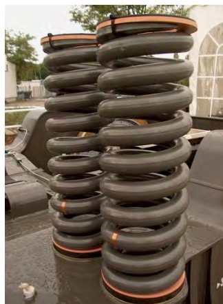
Obr. 1 Příklad použití šroubové pružiny v sekundárním vypružení železničního vozidla
