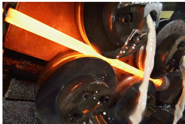
Obr. 2 Indukční ohřev kovacího lisu na vačky
