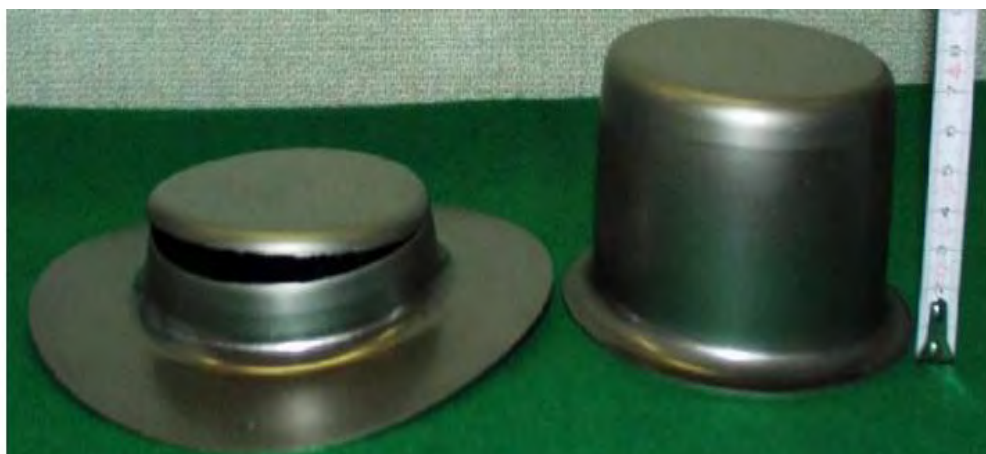
Obr. 2 Výlisky vyrobené ze dvou druhů ocelí se stejnou pevností v tahu ( R_m = 590 MPa): Vlevo – konvenční ocel, vpravo – ocel TRIP[5]
