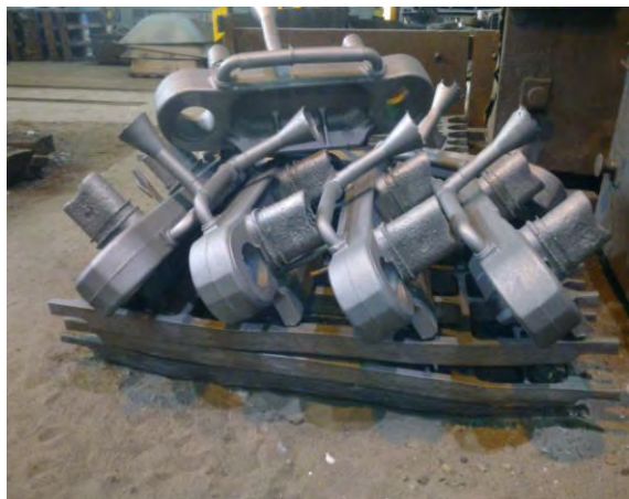
Obr. 1 Odlitky článků se vtokem a nálitky Fig. 1 Castings of links with runners and risers
