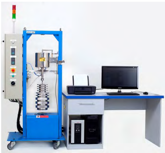
Obr. 5 SPUTT 500 – zařízení pro provádění creepových penetračních zkoušek
