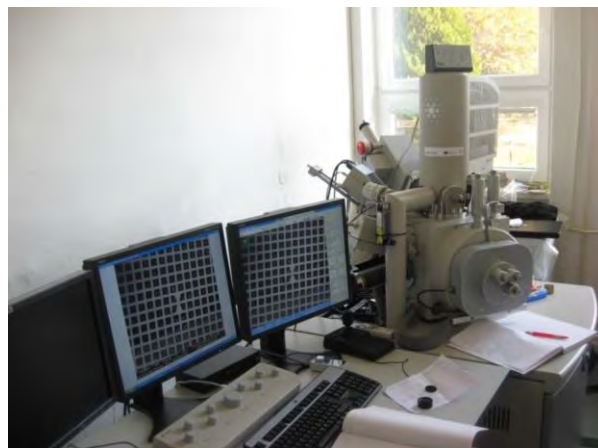
Obr. 6 FEG SEM Quanta 450 s EDX/EBSD/WDX systémem TRIDENT APEX4
