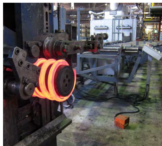
Obr. 3 Navíjení za tepla Fig. 3 Hot coiling
