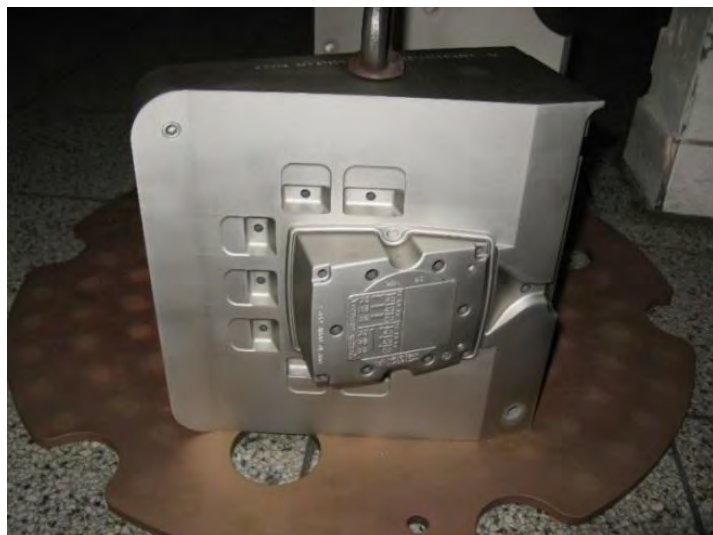
Obr. 12 Aplikace povlaku TiBC na nástrojích pro tlakové lití
