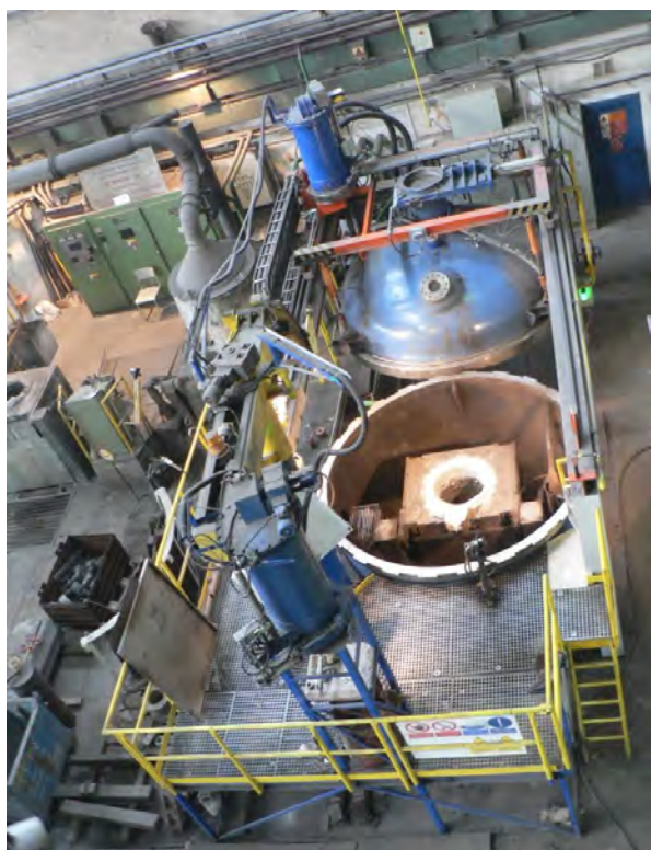
Obr. 1 Vakuově přetlaková indukční tavicí pec Fig. 1 Vacuum and Pressurized Induction Melting Furnace
