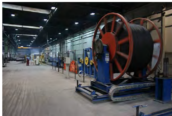
Obr. 4 Linka na výrobu stabilizovaných pramenců
