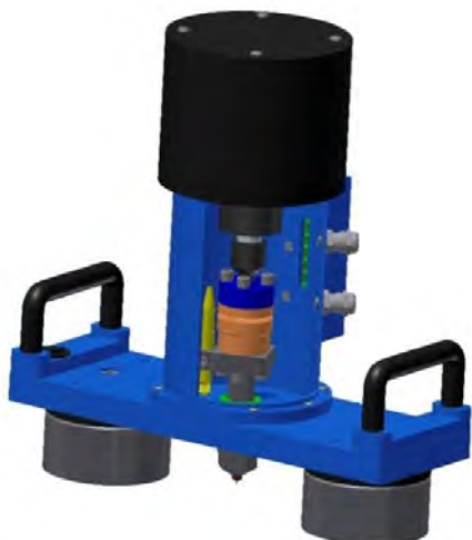
Obr. 3 MABIT – Instrumentální tvrdoměr typu IN-SITU Fig. 3 MABIT – Instrumental portable hardness tester
