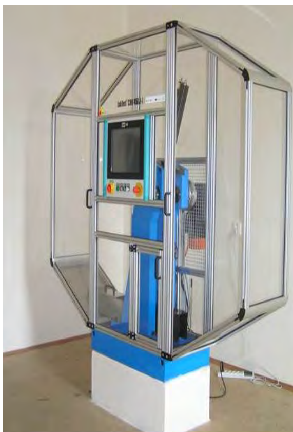
Obr. 4 Instrumentované Charpy kladivo Fig. 4 Instrumented Charpy pendulum
