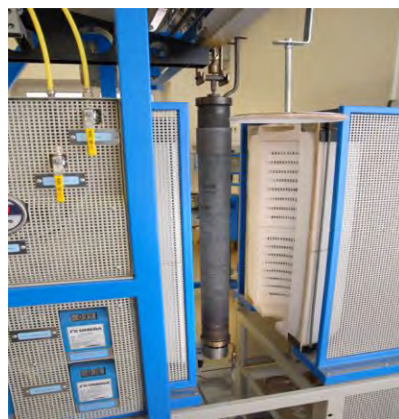
Obr. 4 Laboratorní zařízení pro testování vysokopeční vsázky Fig. 4 Laboratory equipment for testing of blast furnace charge
