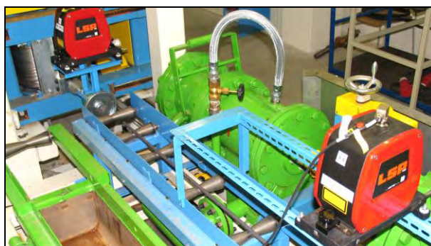
Obr. 3 Volné ochlazování tyčí na vzduchu (zaznamenávání teplot dvěma teplotními skenery)
