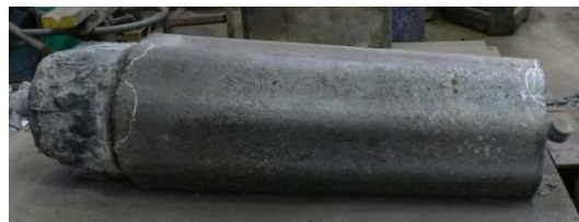
Obr. 10 Odlitý ingot o hmotnosti cca 715 kg Fig. 10 Cast ingot with mass of approx. 715 kg
