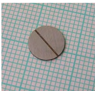
Obr. 8 Zkušební těleso tvaru disku s „U“ vrubem v ose roviny disku Fig. 8 Disc test specimen with „U“ notch in the axis of disc plane
