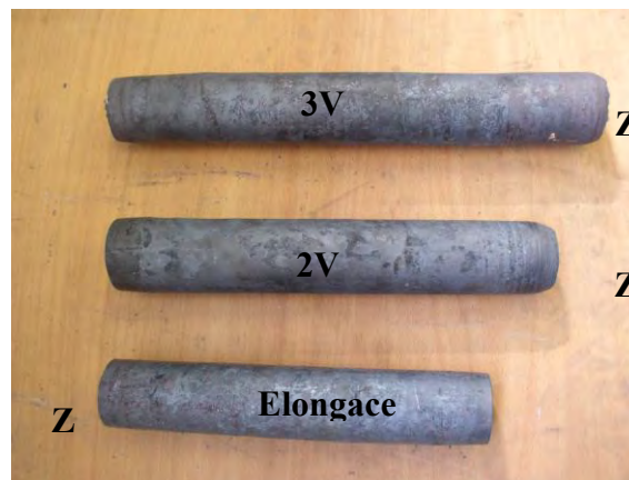
Obr. 8 Vývalky po válcování ve dvou a tří válcové sestavě Fig. 8 Rolled products after rolling on two- and three-roll arrangement
