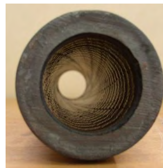
c) Elongovaný vývalek z 3V procesu c) Elongated rolled product from 3V process
