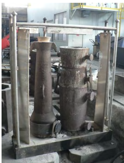
Obr. 7 Lící sestava pro odlévání spodem v kesonu VPIM Fig. 7 Casting unit for bottom casting in the VPIM caisson
