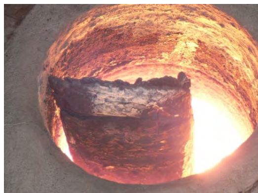
Obr. 6 Materiál z předchozí 1. tavby, po překování je vsázkou 2. tavby
