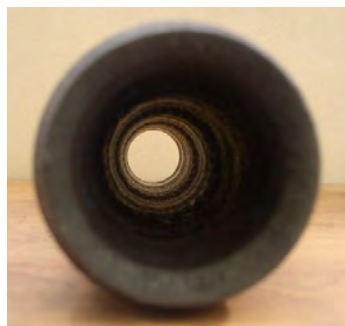
a) Vývalek z 2V procesu a) Rolled product from 2V process
