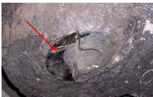
Obr. 3 Detail zatuhlé taveniny v místě výlevky po vyndání z lící pánve. Místo odběru vzorku kovu na analýzu. Fig. 3 Detail of solidified melt at the place of nozzle after its removal from the pouring ladle. Place for taking of sample of metal for analysis.
