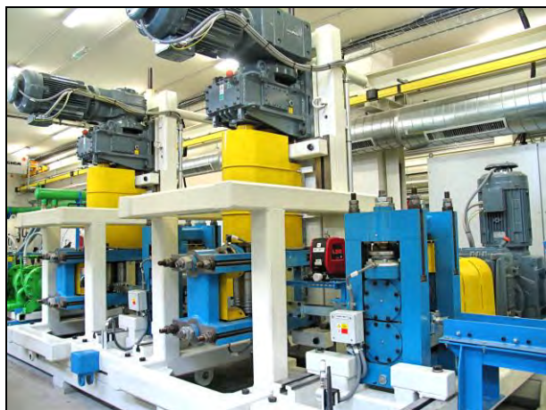
Obr. 1 Horizontální a vertikální válcovací stolice spojitého doválcovacího pořadí
