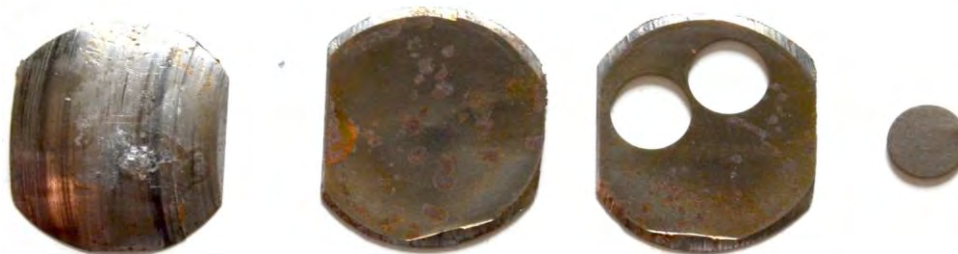
Obr. 2 Postup přípravy penetračních disků ze vzorku materiálu odebraného zařízením Ssam TM -2. Fig. 2 Preparation of disc test specimens of the material sample taken by Ssam TM -2 equipment.
