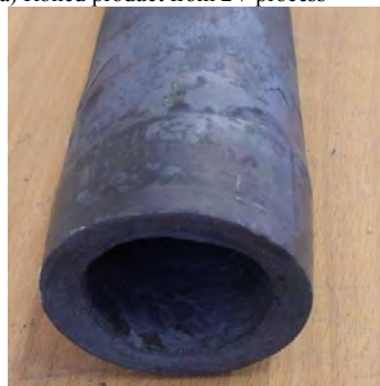
d) Koncová část vývalku z 2V procesu d) End part of the rolled product from 2V process
