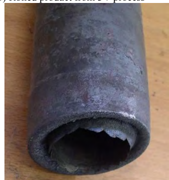
e) Koncová část vývalku z 3V procesu e) End part of the rolled product from 3V process
