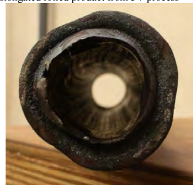
f) Zdeformovaná koncová část vývalku z 3V procesu (tzv. triangulace) f) Deformed end part of the rolled product from 3V process (so called triangulation)
