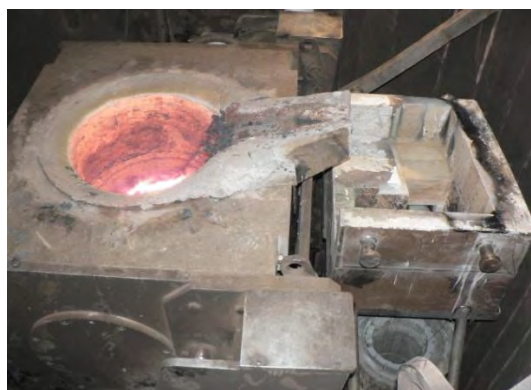
Obr. 8 Lící sestava kesonu s mezipánví Fig. 8 Casting unit of caisson with tundish
