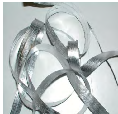
Obr. 2 Produkt rychlého tuhnutí – pásek slitiny Al-11Fe Fig. 2 Rapid solidification product – a ribbon of Al-11Fe alloy
