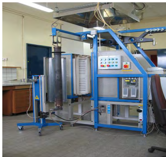
Obr. 5 Zařízení pro fyzikální a metalurgické testování koku metodou Nippon Steel Corporation
