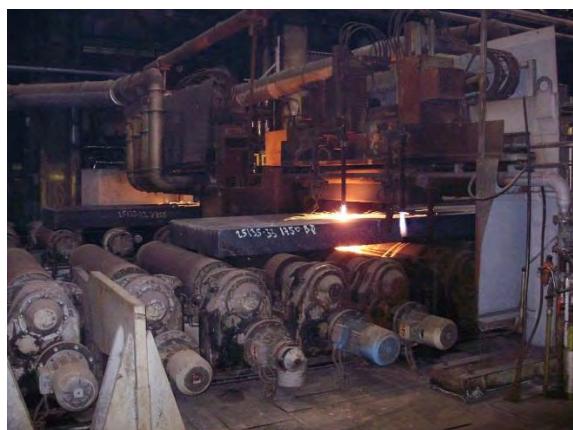
Obr. 3 Měřicí místo u skarfovacího stroje a distribuční rozložení nanočástic v tomto prostoru Fig. 3 Measuring point at the scarfing machine and distribution of aerosol particles in this location
