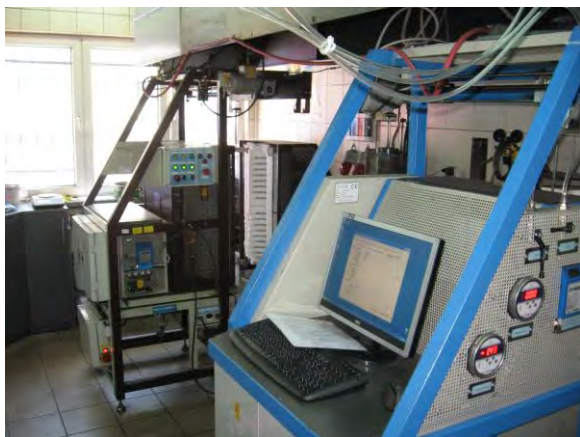
Obr. 6 Laboratoř koksovy v Polsku, kterou firma DASFOS vybavila jak zařízením pro testování koksovateľnosti (v pravé polovině snímku), tak testovacím zařízením CSR/CRI (vlevo) Fig. 6 Laboratory of Polish coke plant equipped with apparatus for coke testing (on the right) and CSR/CRI testing (on the left) by DASFOS company
