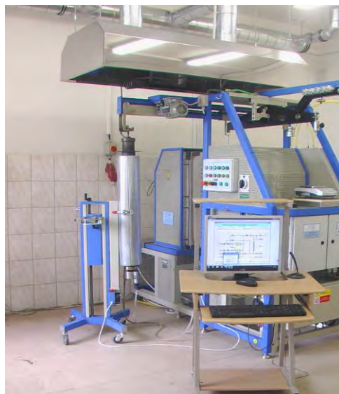
Obr. 1 Nově instalované zařízení pro měření redukovatelnosti (ISO 4695:2007), relativní redukovatelnosti (ISO 7215:2007) a pevnosti po redukci za nízkých teplot (ISO 4696 - 1:2007 a ISO 4696 - 2:2007)
