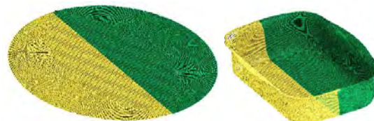
Obr. 3 Simulácia hlbokého ťahania obdĺžnikovej nádoby
