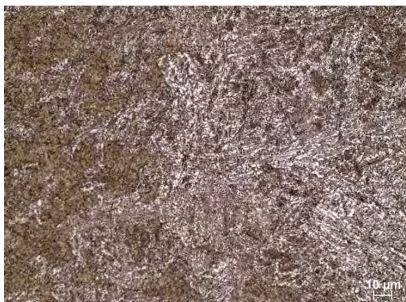
Obr. 5 Svar č. 1 – perlitická struktura (výchozí stav oceli 56NiCrMoV7).
