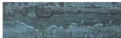
Obr. 4 Povrchová vada na válcovaném profilu Fig. 4 Surface defect on the rolled profile
