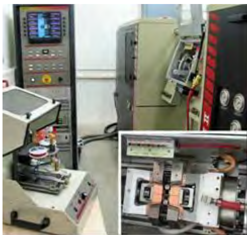
Obr. 1 Sestava simulátoru HDS-20 s pohledem do pracovní vakuové komory (výřez vpravo dole) a s nezbytnou svářečkou termočlávkových drátů (vlevo dole)
