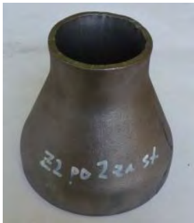
Obr. 1 Rúra Z po viacstupňovom tvárnení Fig. 1 Tube "Z" after multistage forming
