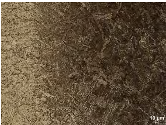
Obr. 3 Svar č. 1 – hranice mezi svarem a materiálem 56NiCrMoV7, velmi hrubý martenzit.
