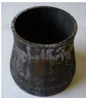
Obr. 3 Rúra N po jednostupňovom tvárnení Fig. 3 Tube "N" after multistage forming
