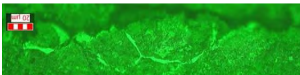
Obr. 8 Oduhličená oblast na části s nátěrem šamotu a boraxu - detail (měřítko 20 μm)
