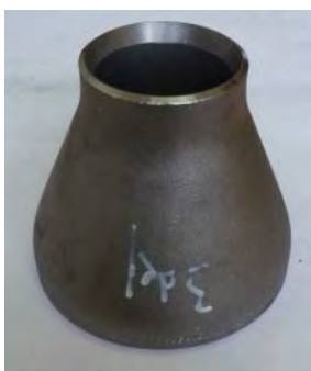
Obr. 2 Rúra D po viacstupňovom tvárnení Fig. 2 Tube "D" after multistage forming
