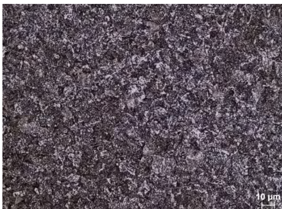
Obr. 4 Svar č. 1 – velmi jemná homogenní perlitická struktura.
