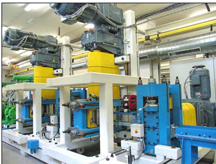
Čtyři válcovací stolice spojitého hotovního pořadí.
