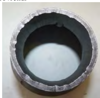
Obr. 5 Rúra Z – zvlínenie obvodu rúry a trhlína Fig. 5 Tube "Z" – waves around the tube perimeter and crack
