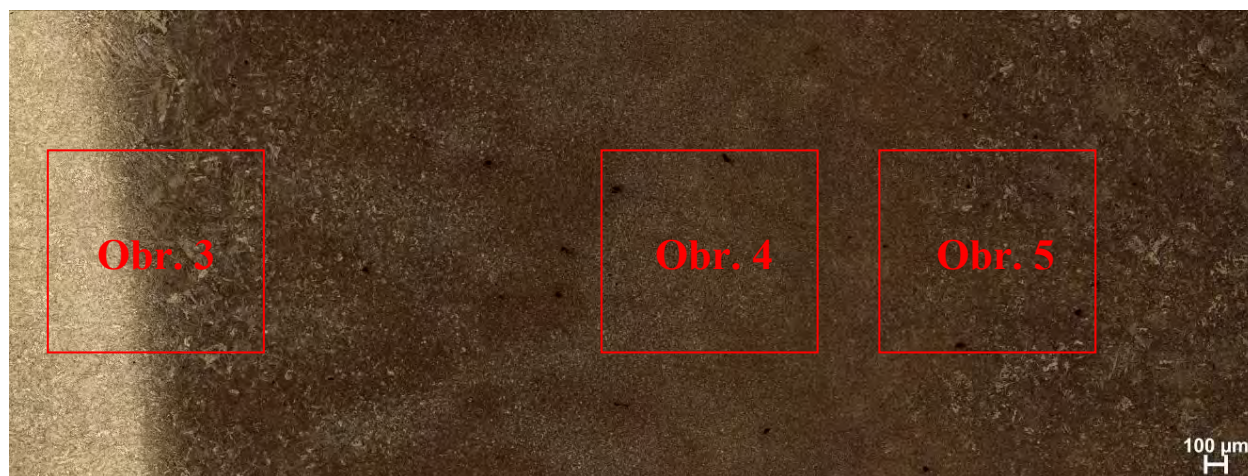
Obr. 2 Svar č. 1 – tepelně ovlivněná oblast mezi svarem a 56NiCrMoV7, celkový pohled, jednotlivé oblasti jsou zobrazeny na snímcích obr. 3 až 5.
