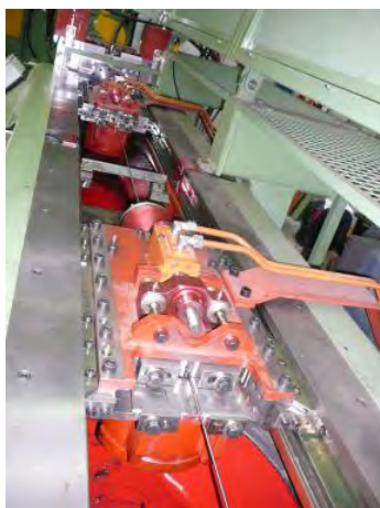
Obr. 3 Tažný stroj – tažné vozíky Fig. 3 Drawing mill – pulling cart.
