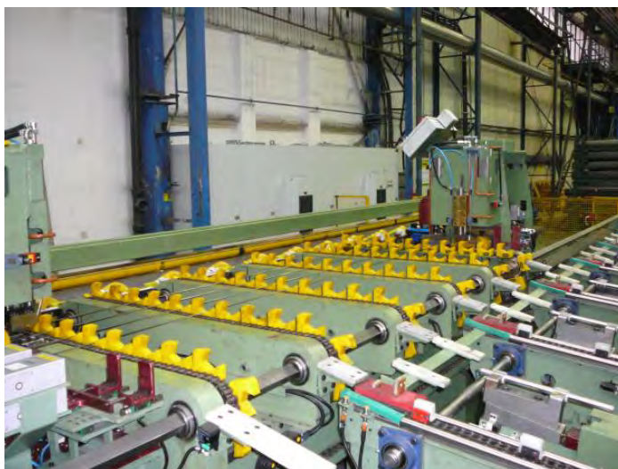
Obr. 5 Frézovací stroj s příčným řetězovým posuvem Fig. 5 Milling machine with transverse chain shift
