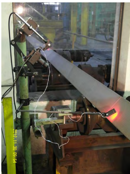
Obr. 6 Snímání povrchu sochoru laserovým profiloměrem Fig. 6 Surface scan of the billet
